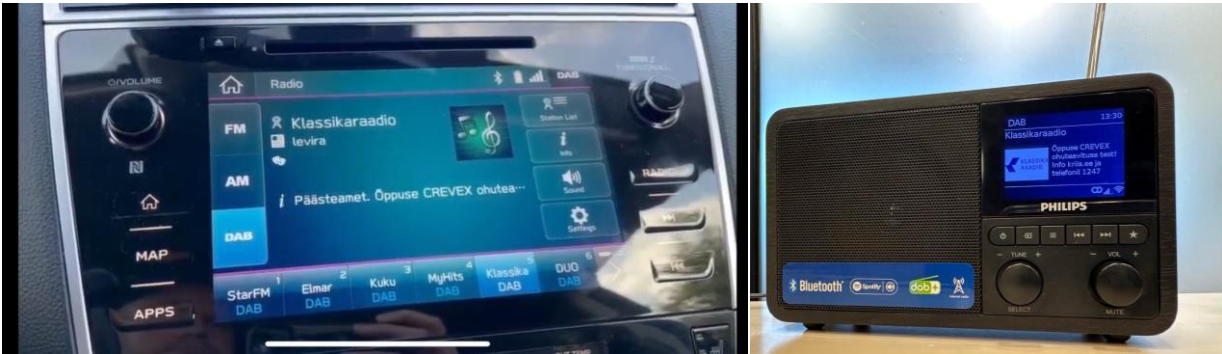
Joonis 10. DAB+ ohuteavitus õppusel autoraadios (vasakul) ja kõögiraadios (paremal)
