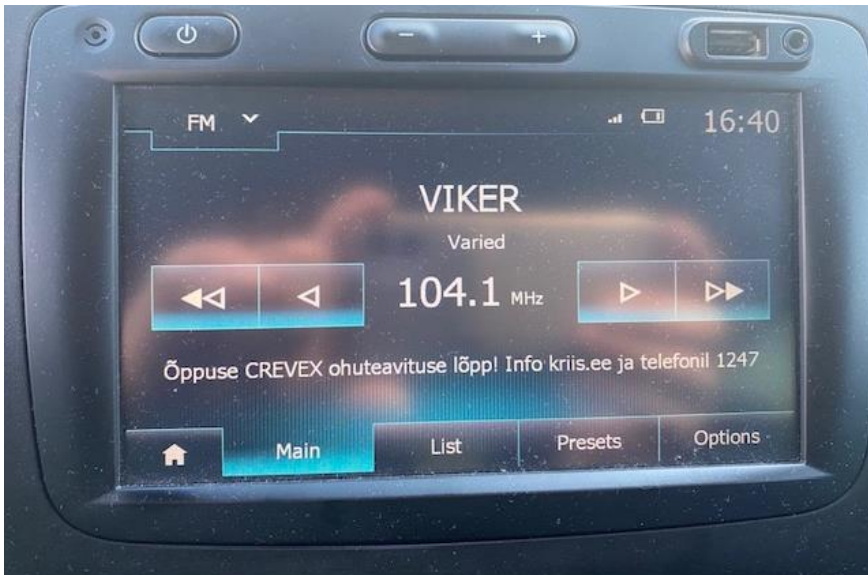
Joonis 7. RDS ohuteavitus õppusel
